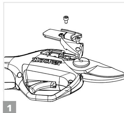
1. Aprire il coperchio per la pulizia e la manutenzione delle lame, facendo attenzione a non rompere la clip di fissaggio del coperchio di ispezione più piccolo.
