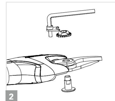
2. Allentare il bullone a clip di regolazione. Rimuovere il bullone e la clip di regolazione. Allentare il dado di tenuta. Rimuovere il dado di regolazione.
